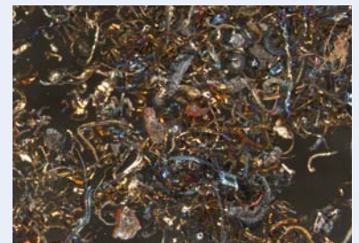
Cavacos produzidos com discos de desbaste ou discos lamelares convencionais. Coloração azul devido ao superaquecimento.
