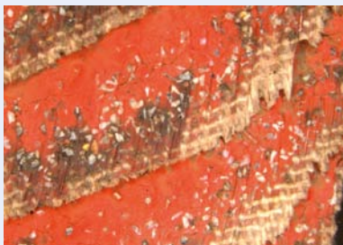
Padrão de desgaste típico com seu filme de arrefecimento caracteristicamente brilhante (sem "vitrificação").
