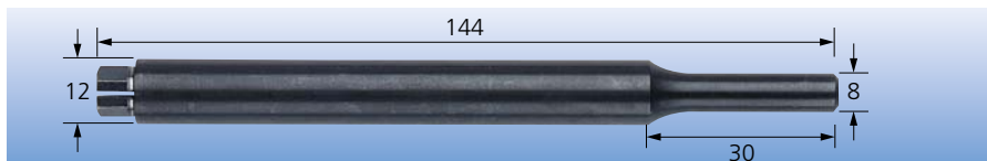
Extensão SPV 100-6 S8 para diâmetro de eixo 6 mm
